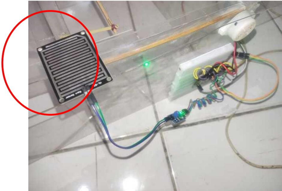
Gambar Implementasi Rangkaian Sensor *Raindrop*
